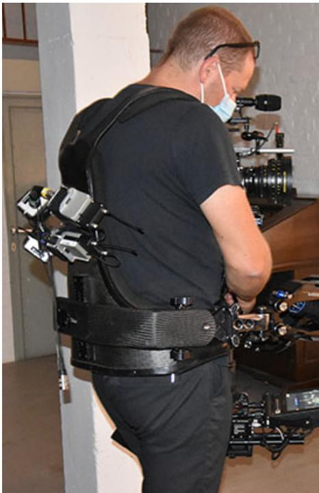
Micro AMBEO VR monté sur la caméra avec quatre émetteurs de poche SK 6000 pour un fonctionnement sans fil
